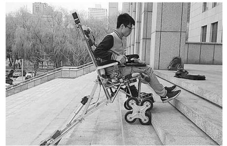
科技日报讯(记者郝晓明)坐在轮椅上能够自如地上下楼梯是残障人士的梦想。日前,一款由东北大学大三学生设计制作的新一代欠驱动自适应爬楼梯轮椅在东北大学亮相,这款新型轮椅在保障稳定性的同时,还能让轮椅上的残障人士正向“迈步”走楼梯。目前市场上的轮椅在爬楼梯过程中,不能正向上下,多是需要倒退上楼,有的还需要他人辅助,使用起来诸多不便,该项目组在国内率先采用了后支架结构的变形技术来使轮椅满足正向上下楼梯的要求,项目负责人黄伟康同学介绍,利用后支架结构的变形技术,其优势在于无需任何特殊装置或者操作,就能够自己适应不同的路况和台阶,而且平稳性和安全性都有技术保障。经过两年多的研究实践,他们将履带和行星轮系结合到一起,在后支架做了一个履带式的从动结构,减少了动力源,在下楼梯的时候能够起到辅助平衡的作用,并能延长轮椅的寿命,载重量也提高到80公斤。
