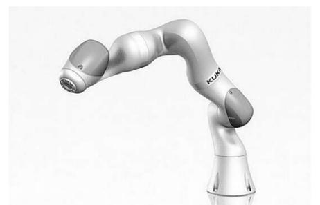
像人的手臂一样的机器人正缓缓地酒杯内倒酒,其间如果人们不小心碰到它,这位“倒酒师”会上马停止,以避免碰撞到对方。这种实现了人机交互功能的七轴机器人LBriiwa,来自于有着全球机器人“四大家族”之称的库卡。这家去年还是德国企业的机器人公司,在实现了大股东易主后,8月28日,首次跟随它的佛山新老板——美的集团来到第三届珠江西岸先进装备制造业投资贸易洽谈会现场,并一举成为展会的关注焦点,频频为观展者“倒上一杯”。和一般需要用防护栏隔开的机器人不同,库卡展示的这款机器人并没有设置任何围栏,能够与人亲密接触。“这款机器人每一个轴里都带有力距传感器,通过采集到的力距能够保护机器人和工作人员本身。”库卡大客户经理王志望说。话音刚落,王志望轻轻地触碰旁边这位“倒酒师”,机器人马上停止倒酒。“我再碰它一下,它就会继续倒酒。”他说,这款具有极高灵敏度和安全性的产品更加适用于柔性、灵活度和精度要求比较高的行业,比如电子、医药、精密仪器等工业。
