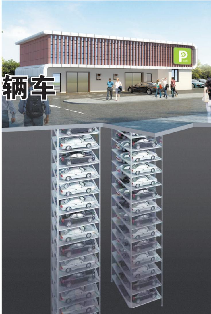
徐明锋觉得这种车库最大的好处是节约空间。他告诉记者,电梯式地下车库垂直向下,开发利用深层地下空间,这样就可以利用城市特别是中心区的边角土地。“地面和传统的地下停车场,50平方米只能停3辆车,但要把高耸的立体停车楼搬到地下,50平方米可以停50辆车。”
