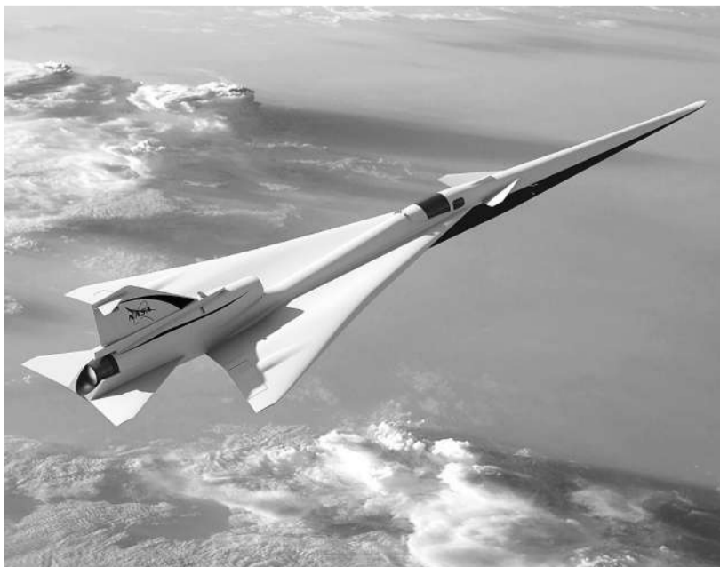
图为NASA计划中的低音爆飞行演示飞机,是NASA和洛克希德·马丁公司刚刚完成的静音超音速运输机的设计原型。图片来源:NASA官网
