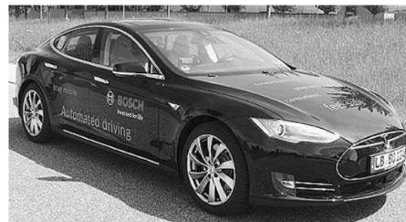
据外媒cnet报道，日前，博世在德国展示了一种与当前汽车导航系统相类似的解决方案。一旦进入自动驾驶区域，驾驶员只需按下方向盘上的两个按钮即可让汽车自动驾驶。当汽车即将驶出自动驾驶区域之前，中控显示屏又开始距离倒计时。当需要人类驾驶员重新控制汽车之前，屏幕则会跳出警告信息并发出警报。
