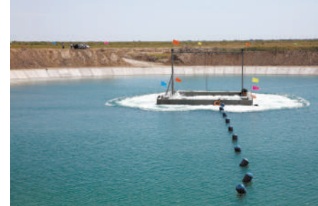
上图为新疆呼图壁气枪地震信号发射台，置于50000吨人工水池中间；下图为激发瞬间。
