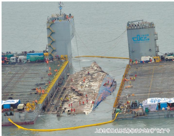
上海打捞局采用钢梁托底方式打捞“世越”号
