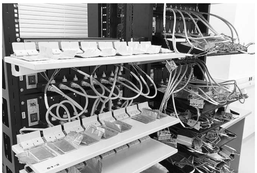
手机快充电池充电和放电测试平台。
