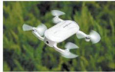
昊翔发布的这款名为清风的无人机，依然延续小型化的定位。脚架进行了折叠设计，飞行前只需要手动将脚架掰开放下，即可轻松起飞。和 DOBBY 一样，Breeze 清风同样采用手机 APP 控制，最大 100 米图传距离，飞行高度限制在 80 米，最大飞行速度每秒 5 米，可实现平缓稳定的飞行姿态。预设的“旅途模式”和“环绕模式”能让 Breeze 清风智能化飞行。前者能实现拉远的效果，后者
