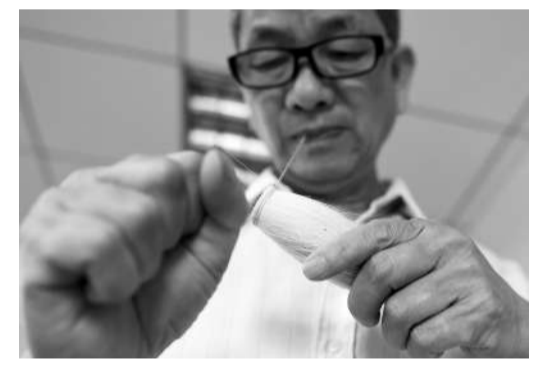
在广西宾阳县宾州镇大罗村,毛笔传统制作工艺至今已有多百年历史。一支毛笔的制作从选料到完工,要历经120多道工序,当地毛笔制作艺人将制作毛笔的技艺代代相传,锲而不舍地传承着百年工匠精神。 图为4月21日,在广西宾阳县宾州镇,65岁的大罗村毛笔老艺人罗儒供在扎笔头。 新华社记者 陆波岸摄
