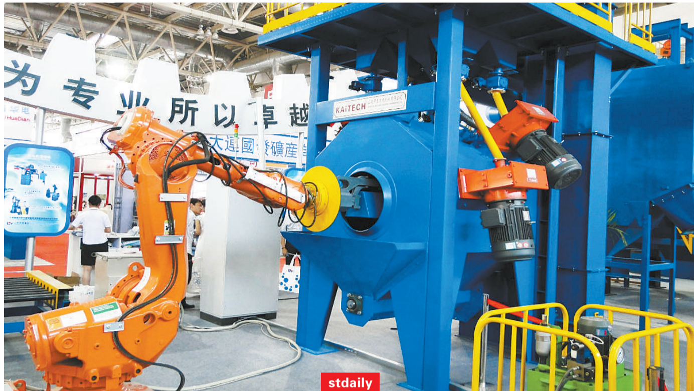
山东开泰集团自主研发的机械手抛丸清理机
