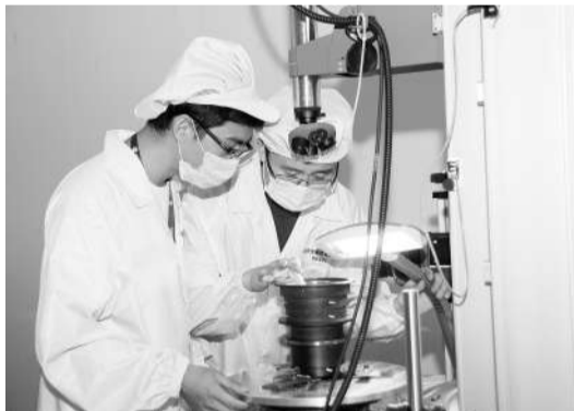
图为技术人员正在进行光学镜头实验室定心装调
