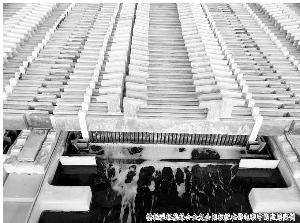
栅栏型铝基合金复合阳极板在电积中的应用实例
