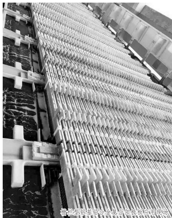
栅栏型铝基合金复合阳极板应用现场
