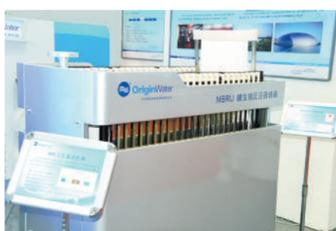
▲碧水源膜生物反应器组件和形似空心粉的膜材料
