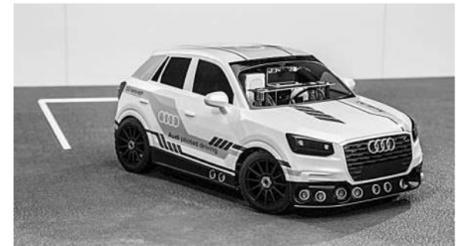
据美国媒体报道,奥迪公司日前发布了一款特别的Q2跨界车,能够自主寻找停车位并自动泊车。该车是一辆研发模型车,尺寸仅为常规版的1/8大小,但其所采用的技术将在奥迪未来车型中推广。奥迪在西班牙巴塞罗那的会议上详细说明这项人工智能技术。现场演示时,1/8的模型车“Audi Q2 Deep Learning Concept”将在3米见方的空间内,寻找利用金属框围起来的停车位,在没有外部支援的情况下自动泊车。利用车载CPU对前方配备的2个摄像头、后方配备的1个摄像头以及安装在车辆周围的10个超声波传感器获得的信息进行分析,从而掌握车辆和停车位的位置关系。然后计算出移动到停车位的方法,根据情况进行转向操作和前后移动,将车辆停在停车位上。
