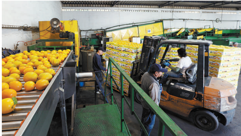
建设在莫沙夫内用于柑橘处理和包装的车间。新采摘柑橘在这里洗净、打蜡、分类和装箱,然后运出上市。
