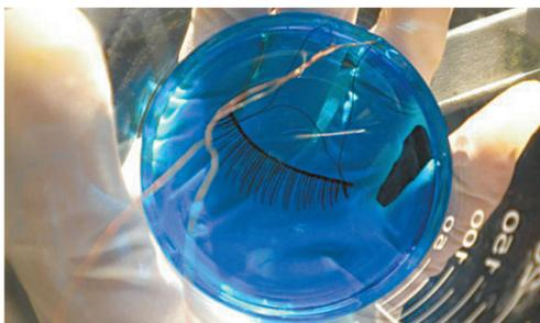
凯塔·维嘉的团队研制的导电假睫毛。佩戴者进行眨眼等动作时，可以激活LED灯管。
