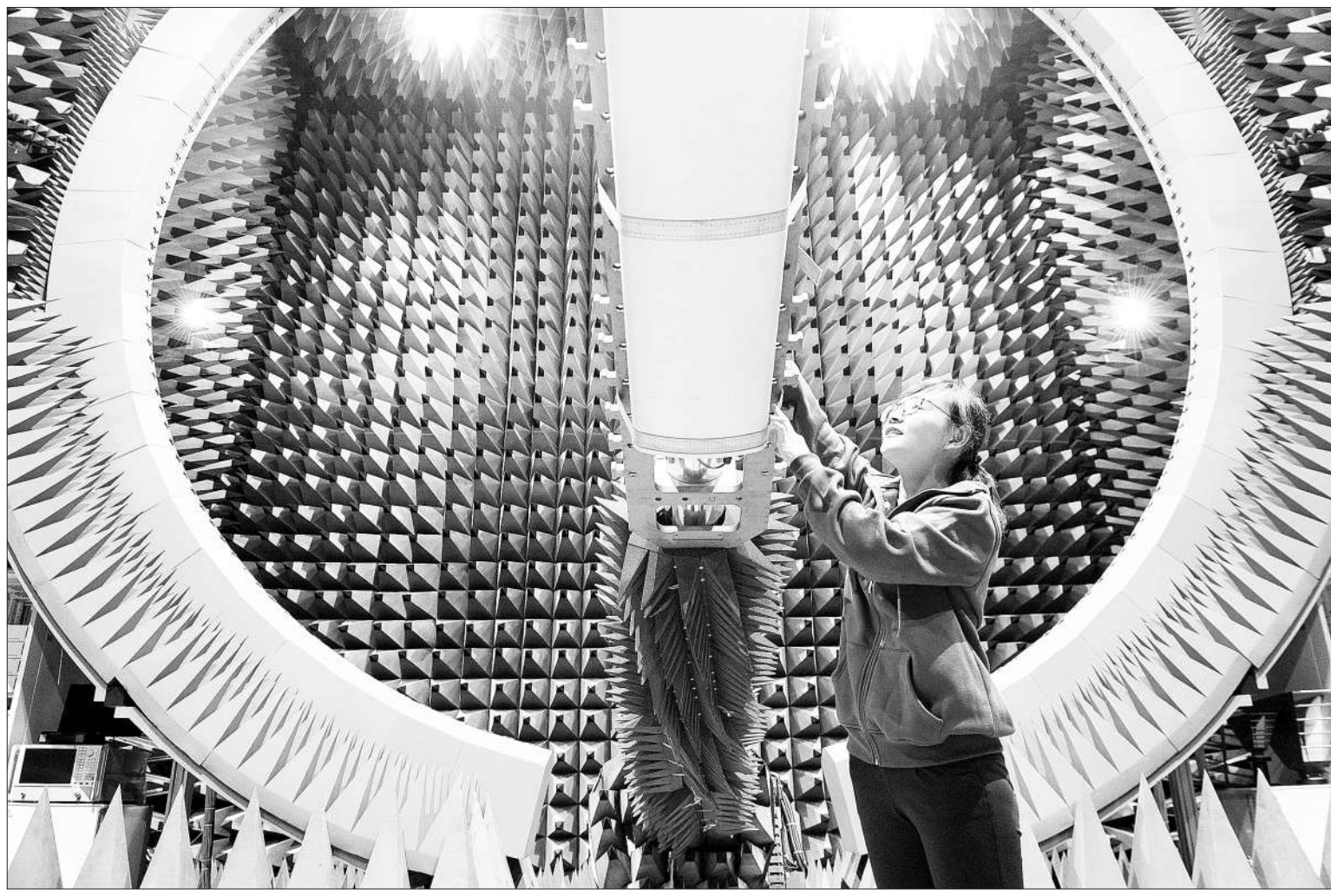
近日,国内最大的运用新技术设备的无线检测实验室在广东省深圳市新益技术有限公司落成,并将对外开放提供检测服务,该实验室的建立将会大大降低行业企业的研发成本。无线技术在日常生活中的应用非常普遍,比如,民用领域的无线技术包括手机、路由器、笔记本上网、鼠标、蓝牙、物联网等;军用领域最常用的雷达系统、北斗卫星以及GPS。图为技术人员正在近场测试场对基站天线进行测试。
