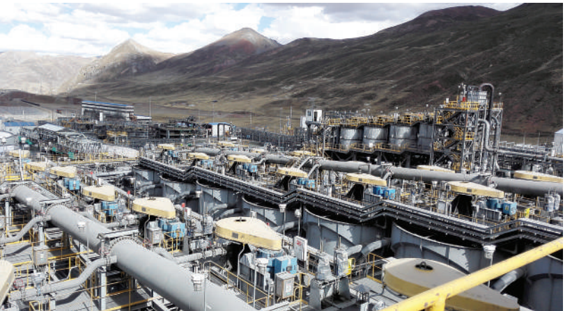
“浮选机大型化关键技术及工业化应用”获国家科技进步二等奖，320立方米充气式浮选机应用于中铝秘鲁TOROMOCHO矿。
