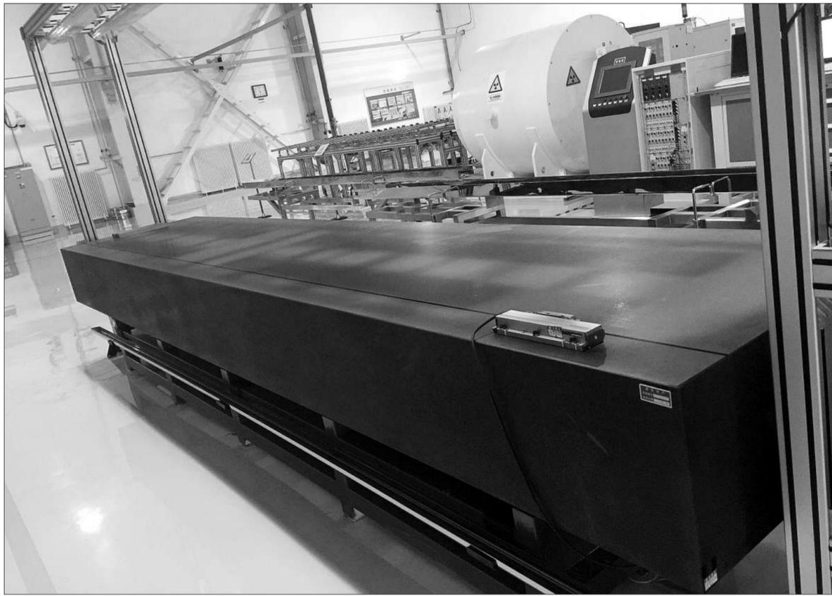
10月26日,中核集团首次向媒体开放其燃料棒生产车间。在中核北方核燃料元件厂AP1000燃料元件车间,用来检测燃料棒平直度的检测台,堪称世界上最平的平
