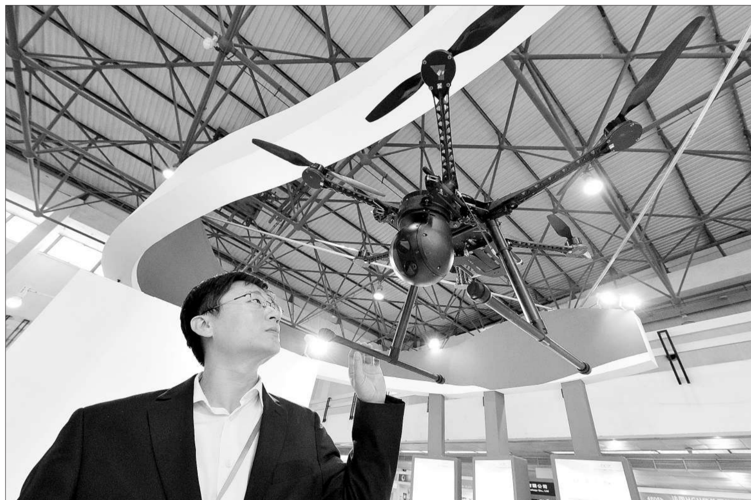
10月17日至19日，2016中国国际激光、光电子及光电显示产品展览会在北京中国国际展览中心举行。展览展示了相关领域的最新产品和技术。图为参展商展示的用于自然生态保护，具有多光谱成像功能的无人飞行器。该飞行器主要应用于自然保护区动植物种群监测和森林烟火监控等领域。本报记者 洪星摄
