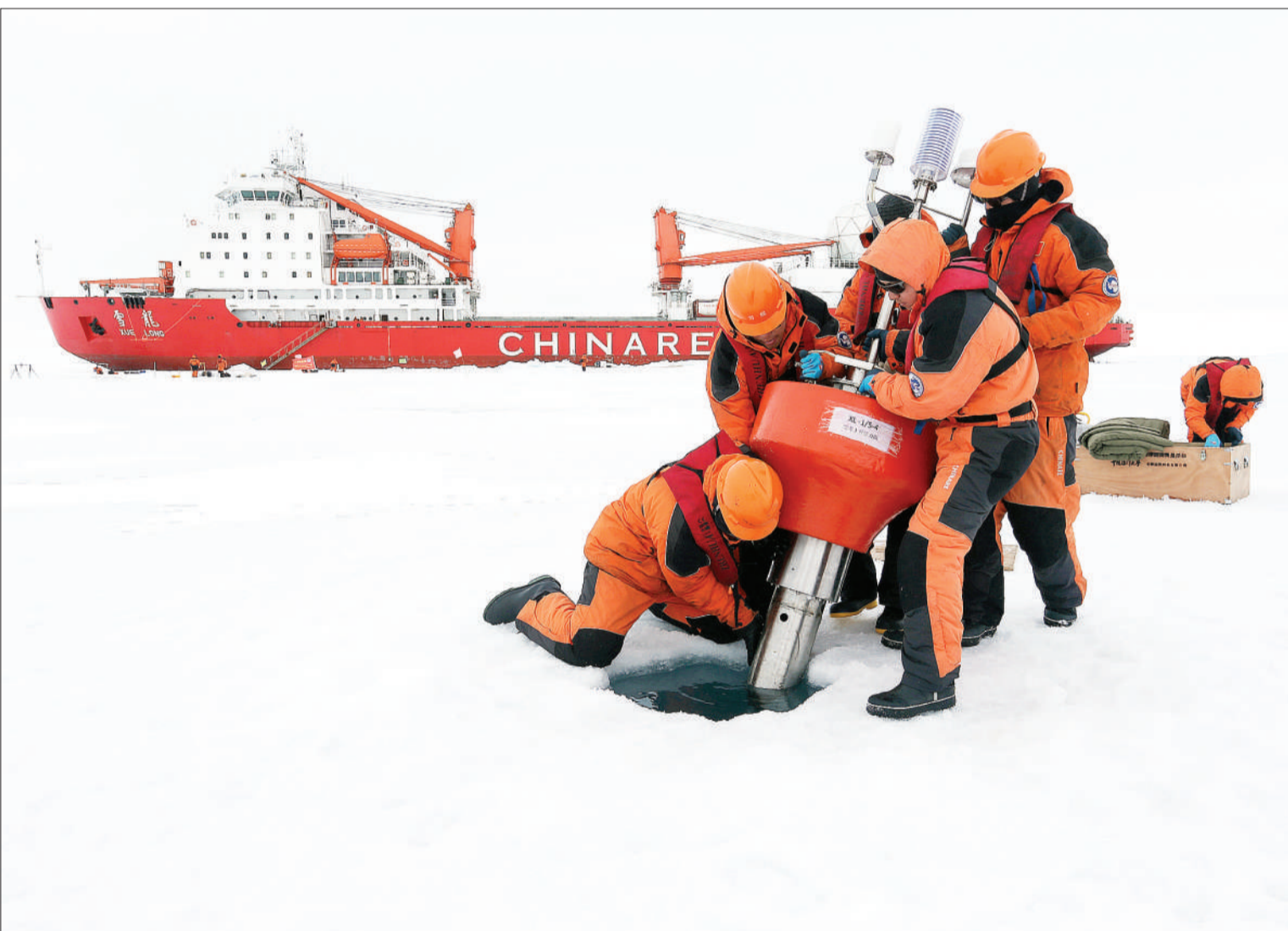
8月20日,中国第七次北极科考队结束了全部六个短期冰站和一个长期冰站的作业,开始返回低纬度海域继续进行北冰洋大洋作业。“雪龙”号预计将于9月26日返回上海。图为8月18日考察队员在短期冰站布放我国自主研发的冰基拖曳式海洋剖面浮标。新华社记者 伍岳摄
