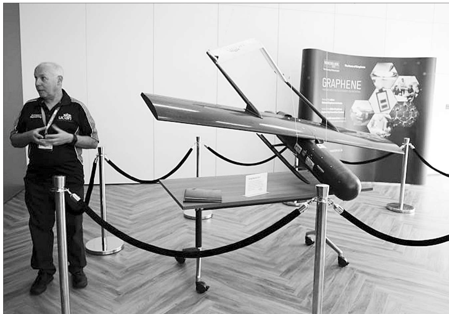
图为在英国国家石墨烯研究院展厅中展出的首架石墨烯无人机模型,其部分部件将采用石墨烯复合材料,旨在研究其在减阻、热控制和保护航空航天器免受雷击等方面的潜在效果。 科技日报记者 郑焱斌摄
