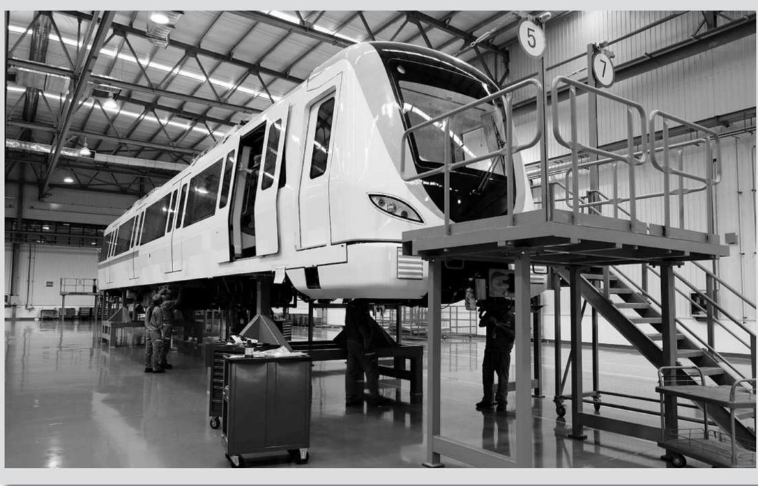
日前,南宁地铁1号线东段通车试运营,标志着南宁迈入了地铁时代。目前,南宁地铁列车已经实现本地化生产,填补了广西轨道交通车辆生产空白,也意味着南宁高端装备业踏上了一个全新的起点,将成为中国中车辐射西南及东盟地区的重要制造基地。图为7月20日,在南宁中车轨道交通装备有限公司生产基地,工作人员在对地铁列车进行组装调试。
