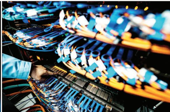
上图“神威·太湖之光”超级计算机(6月20日摄)。左下图一名研发工程师展示“神威·太湖之光”所使用的“申威26010”众核处理器(6月16日摄)。该处理器采用64位自主申威指令系统,峰值性能3.168亿亿次每秒,核心工作频率1.5GHz。“神威·太湖之光”里安装有40960个这样的处理器。右下图“神威·太湖之光”超级计算机的交换机网线(6月16日摄)。“神威·太湖之光”采用大规模高流量复合网络体系结构,实现全系统高带宽、低延迟通信。新华社记者 李响摄
