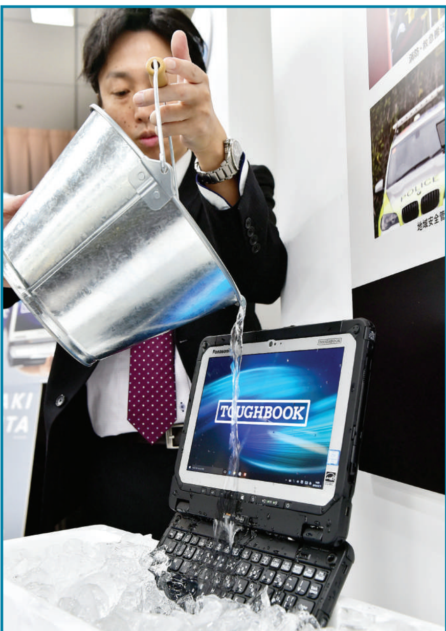
2015年12月21日,日本电子巨头松下展示新款重型笔记本电脑,这款电脑轻量级加固型笔记本仅重1.76公斤,但是具备防水、防尘、防撞和防震等强大的镁合金“身体”。
