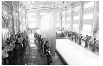
近日，位于“中国宣纸之乡”安徽泾县的中国宣纸股份有限公司向宣纸抄制的极限发起挑战，经44名技艺精湛的捞纸师傅携手抄制，一张长达11.4米、宽达3.6米的“超级宣纸”成功诞生。目前，“超级宣纸”已实现量产，每天可抄制约70张。图为在“超级宣纸”生产车间，工人正在进行提帘作业。
