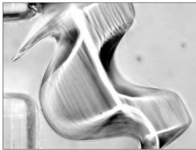
用“瞬态光学液体成型”3D打印技术打印出的长度约500微米的物件。
