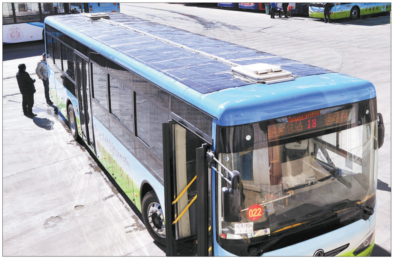
近日,刚从拉萨市科技局完成参数检测的西藏首辆太阳能公交车正式进入营运阶段。这辆公交车在车顶覆盖了32块太阳能光伏板。借助太阳能,车辆在行进间就能实现运行所需电力的及时补充,充满电后可以维持公交车运行两百多公里。新华社记者 晋美多吉摄
