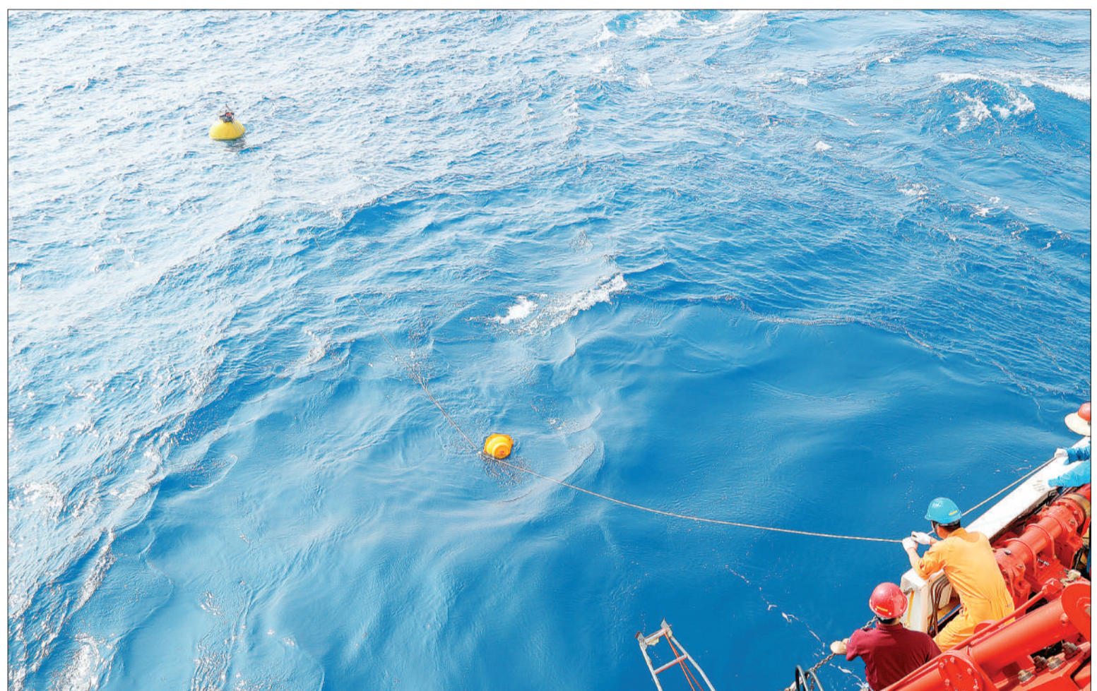
11月15日,我国新一代海洋综合科考船“科学”号在完成2015年热带西太平洋主流系和暖池综合考察航次后,返回青岛母港。这个航次开创了单一科考航次布放、回收深海潜标套数和观测设备数量最多的世界纪录,并在热带西太平洋初步建成潜标观测网。图为“科学”号的科考队员在布放深海潜标。
