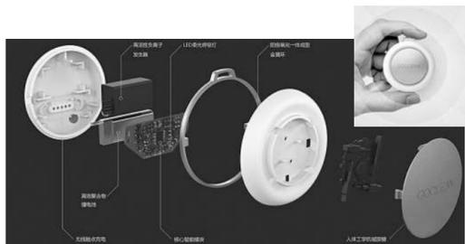
这个投注马川团队心血的创意产品——CoClean随身空气净化器,一改传统空气净化器的设计思维,专注于净化个人周身1立方米内的空气。采用基于电晕的离子静电除尘技术,相当于在人周围设立一层保护膜,而CoClean体积只有表盘大小。
