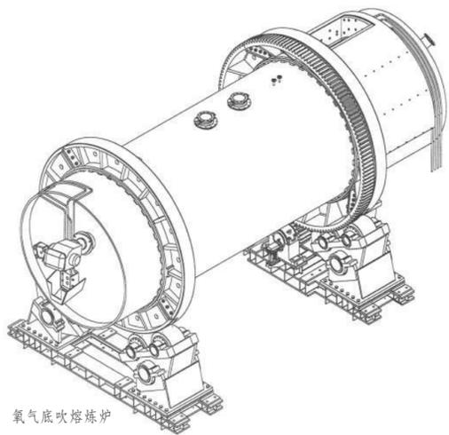
氧气底吹熔炼炉
