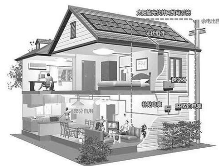
“八度阳光”这个名字中藏着刘一锋的愿景:做家用太阳能系统,力争用太阳能每天为家庭提供8千瓦时生活用电。图为5kW户太阳能系统示意图。
