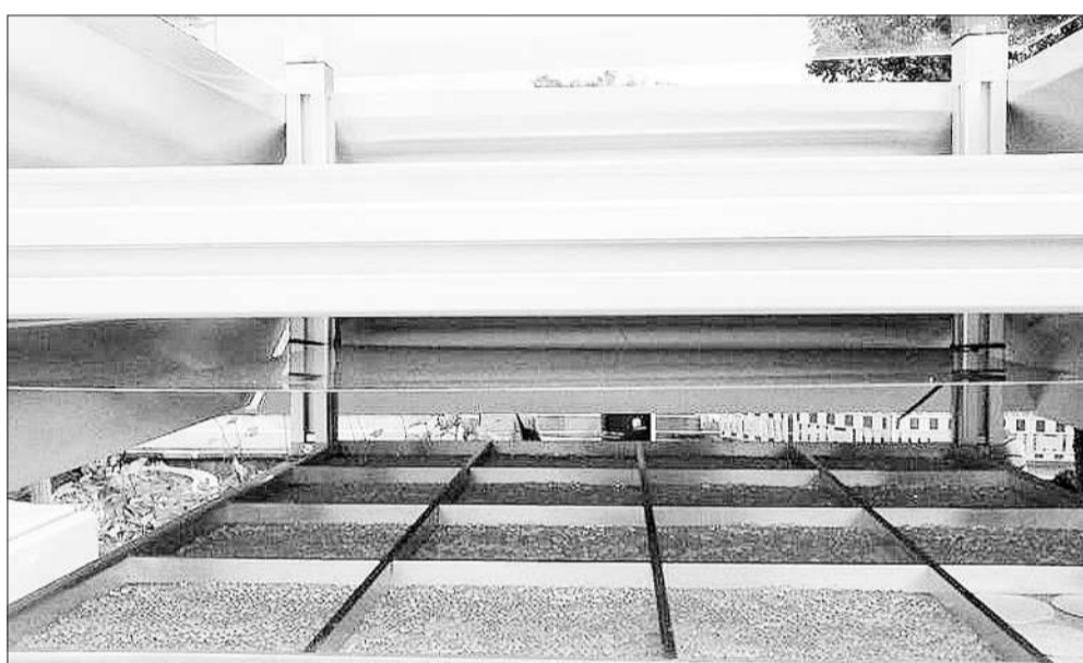
图为研究人员把城市空气中的污垢收集到含有玻璃珠的装置
