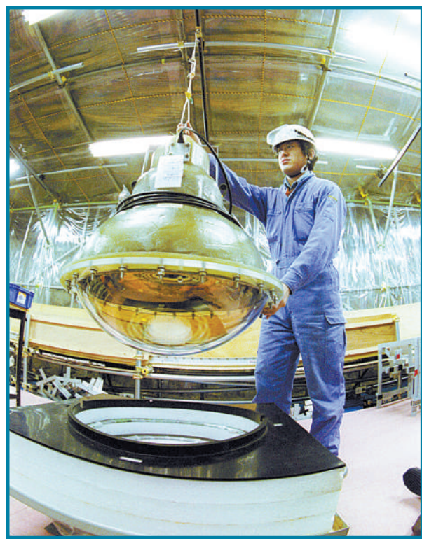
▲▼8月4日,超级神冈探测器是日本建造的大型中微子探测器,位于日本岐阜县的一个深达1000米的废弃矿中,主要部分是一个高41.4米、直径39.3米的圆柱形容器,盛有5万吨高纯度的水,容器的内壁上安装有11200个光电倍增管,用于探测高速中微子在水中通过时产生的切连科夫辐射。
