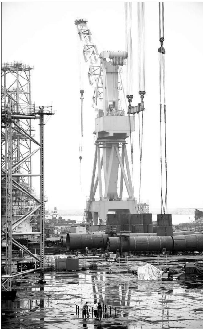
我国自主建造的深水半潜式钻井平台“海洋石油982”目前正在大连船舶重工集团海油工程有限公司建造。据介绍,该钻井平台最大作业水深1500米,最大钻井深度9144米,预计2016年底初步成型。图为工人在进行分段船体组装。
