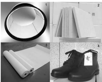
1.数说气凝胶柔性毡的筒型件;2.潜艇冷库用低温型气凝胶板型件;3.气凝胶柔性布;4.配有气凝胶柔性布的武警靴。
