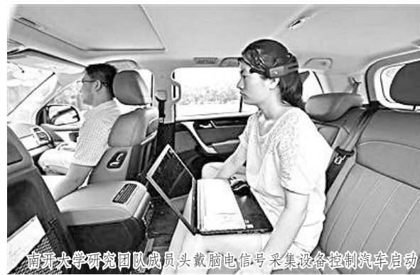
南开大学研究团队成员头戴脑电信号采集设备控制汽车启动
