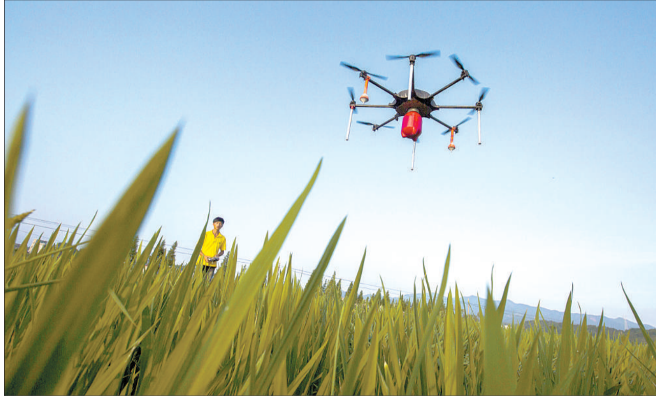
连日,江西省九江市都昌县农业部门联合植保专业合作社,利用无人植保飞机帮助农民进行水稻喷药作业,为农业丰收打下基础。“无人机飞防”作业是运用无人机的特性和功能为农业生产服务,具有成本低、操作简单、农药喷洒覆盖好等特点。新华社发(傅建斌摄)
