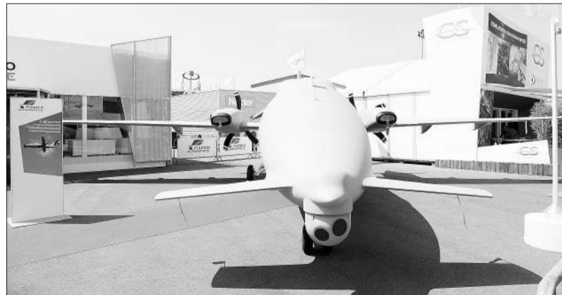
意大利比亚乔公司制造P.11H“锤头”无人机可持续飞行16小时,最高飞行高度13700米。预计将于今年底交付意大利军方首次使用。
