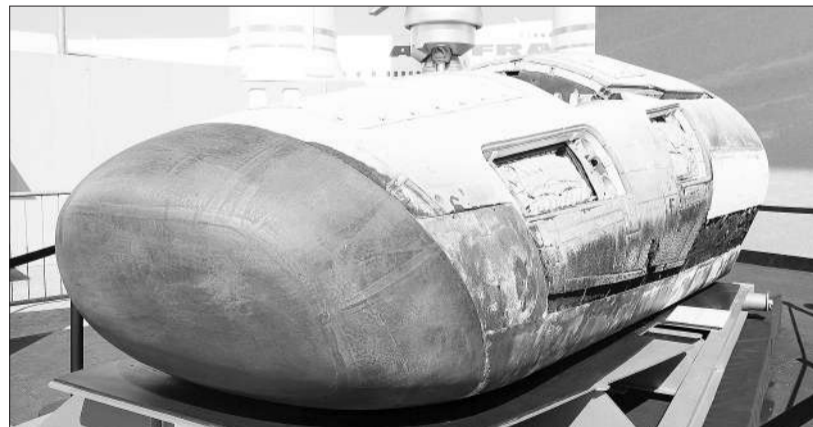
欧洲空间局(ESA)研制的迷你无人航天飞机IXV,用于验证大气层再入技术。其于今年2月11日首次成功试飞,标志着欧洲研制可重复使用航天飞机成功迈出第一步。
