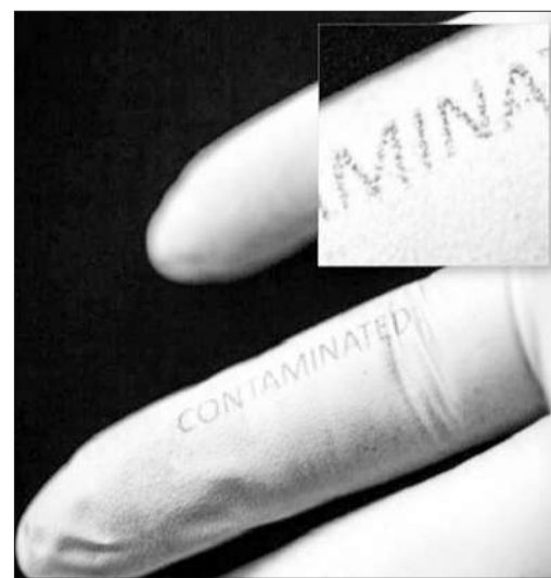
用能感应细菌的聚丁二烯在手术手套上印上单词contaminated(被污染的),当暴露于大肠杆菌时,原本蓝色的单词会变成红色。
