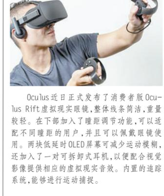
Oculus近日正式发布了消费者版Oculus Rift虚拟现实眼镜,整体线条简洁,重量较轻。在下部加入了瞳距调节功能,可以适配不同瞳距的用户,并且可以佩戴眼镜使用。两块低延迟OLED屏幕可减少运动模糊,还加入了一对可拆卸耳机,以便配合视觉影像提供相应的虚拟现实音效。内置的追踪系统,能够进行运动捕捉。
