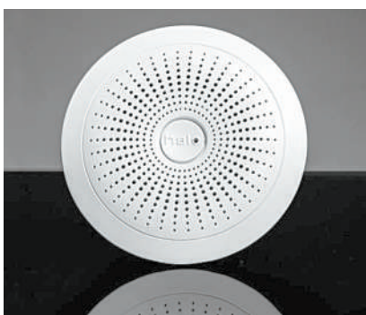
Halo WX是首款能迅速检测闪电、阴燃火和一氧化碳的单一设备,但它的功能不仅局限于此。用户还可以对Halo WX进行设置,使它接收气象部门发送的龙卷风预报信息。它有一个使用期限长达10年的备用电池,因此用户很少会遭遇电池电量低的尴尬。
