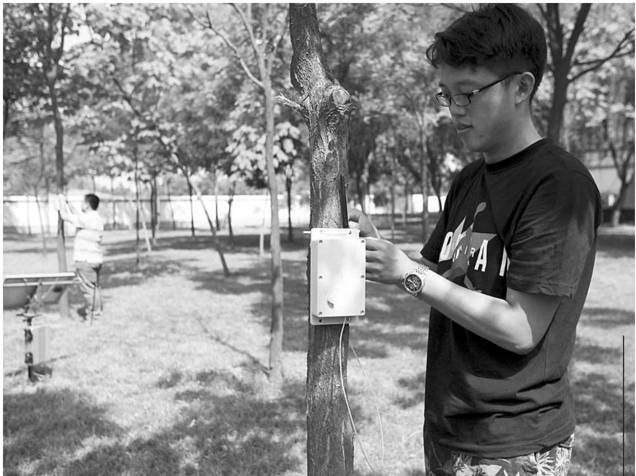
最近,西北大学一科研团队利用物联网技术,正在研发一种专门用于监测生态环境的“神秘盒子”,可监测附近百米内的影像、声音、温度和湿度,还可通过影像识别到底是哪一种动物经过。若此技术广泛应用,能大大减轻护林员工作量。图为西北大学信息科学与技术学院门前的小树林里,科研人员正在调试在树上挂着用于传感监测的盒子。
