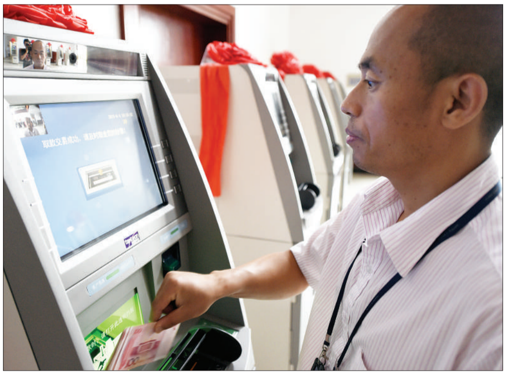
近日,由清华大学与桦昆科技(中国)股份有限公司联合自主研发的、我国首台具有人脸识别功能的ATM机在杭州亮相。据介绍,这台可以“刷脸”的ATM机的原理是通过机器屏幕上方的摄像头,对此设备上操作的人员进行面部图像采集,然后通过与银行、公安等系统联网进行身份识别和比对。若设备所采集到的人脸图像与公安系统采集的身份证登记图像或银行登记照片不符,取款人即使输入密码也无法完成取款操作。图为6月4日,一位研发工作人员演示在具有人脸识别功能的ATM机上取款操作。新华社记者 鞠焕宗摄
