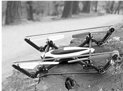
相比带有轮子的四旋翼机,此架四旋翼机则升级为履带配置,在砂石起伏路面上如履平地,速度更是有明显提升,还有摄像头等高级装备可供选。
