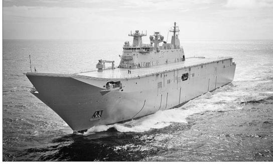
洁平整,舰岛大量采用了大倾斜的斜面设计,将主要的电子设备和雷达天线高度集成到隐身桅杆内,并将鱼雷发射管、硬质救生艇等进行遮挡或放置在舰艇内部,使舰艇的雷达反射面积大大减少。同时,该舰将发动机、辅机以及传动装置等主要的噪声装备安置在减震和隔音的弹性支架上,最大限度降低船体噪声。此外,该舰还在烟囱、机舱等主要的热源上安装了喷水冷却系统,使舰艇的红外信号得到良好控制。
