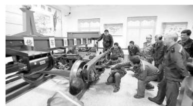
为适应铁路新技术、新设备的需要,锦州车辆段建立岗位技能实训基地,对职工进行技术业务培训,大力提升职工岗位技能。图为该段山海关西运用车间组织职工开展新型转向架知识培训。
