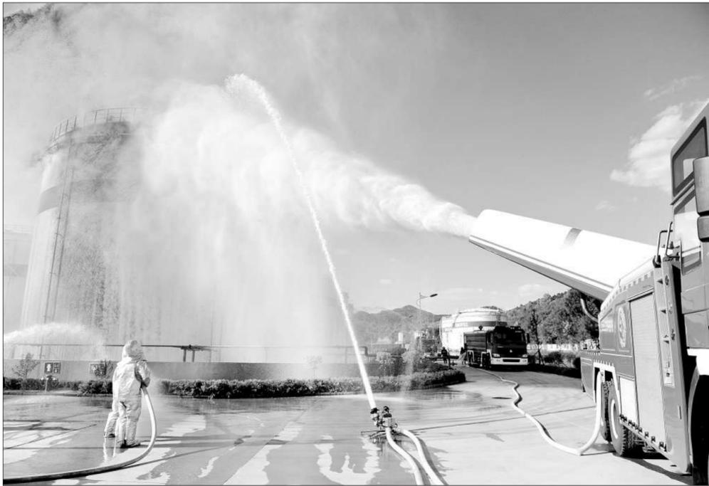
5月20日,河北承德公安消防支队举行石油化工灭火演练,大型消防水炮亮相,并参与演练。据了解,消防水炮利用航空涡轮喷气发动机产生的高速气流作为灭火剂喷射动力,可实现大功率、远距离喷射,提高控火和灭火能力。
