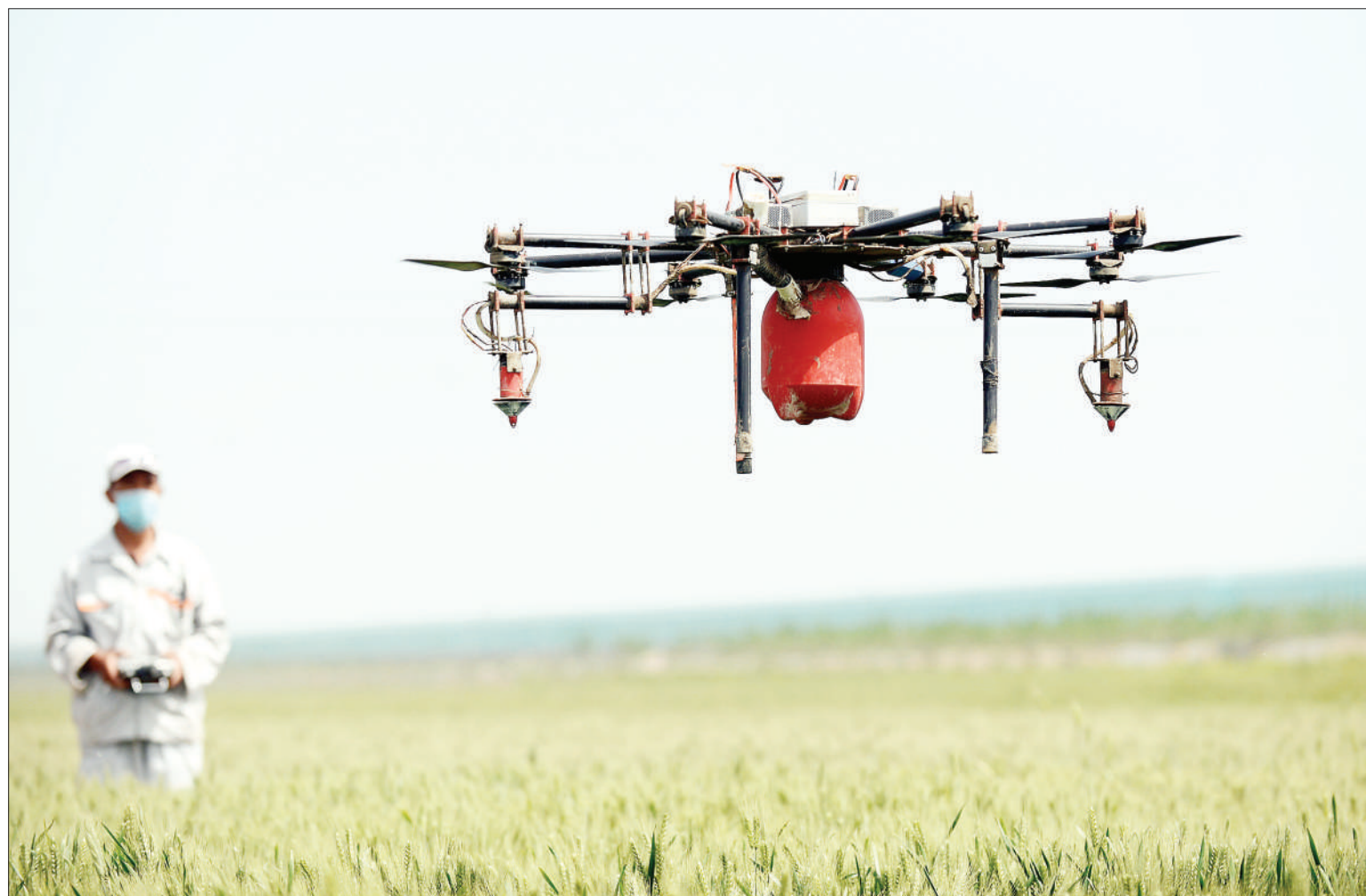
5月19日,河北石家庄市栾城区农业部门联合飞防企业,利用无人植保飞机对小麦进行大规模喷药作业。据了解,无人植保飞机一天可喷洒农药面积200至300亩,极大地提高了作业效率。图为工作人员操作无人植保飞机在石家庄市栾城区温家庄村防治病虫害。
