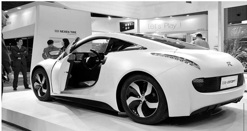
第十六届上海国际汽车工业展览会上，由合工大新能源汽车研究院与上海瑞联科技股份有限公司联合开发研制的“天瑞”纯电动轿跑车功能样车惊艳亮相，功能样车设计最高时速140公里，搭载了28千瓦时的三元锂电池，整车通过轻量化设计制造，整备质量只有800千克，能够确保其在综合工况下续航里程超过280公里，体现“智能、时尚、环保和驾乘乐趣”的设计理念，被媒体誉为“合肥版特斯拉”。
